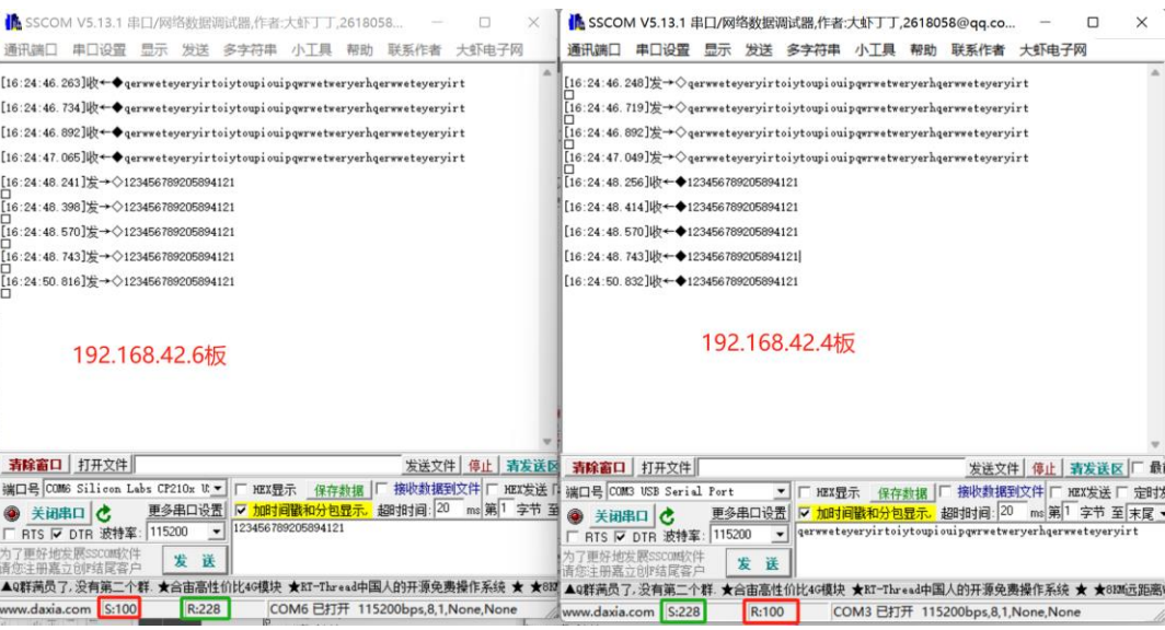
UDP客户端获取192.168.42.4板串口数据如上，配置板子端口号3020
